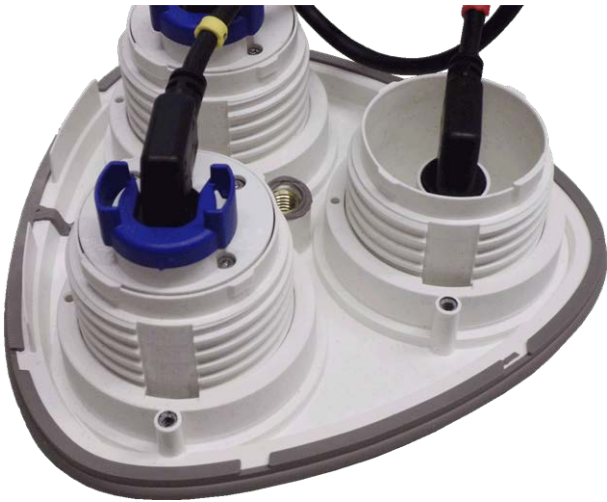
Abb. 13: Frontplatte mit Sensormodulen (Rückseite)
