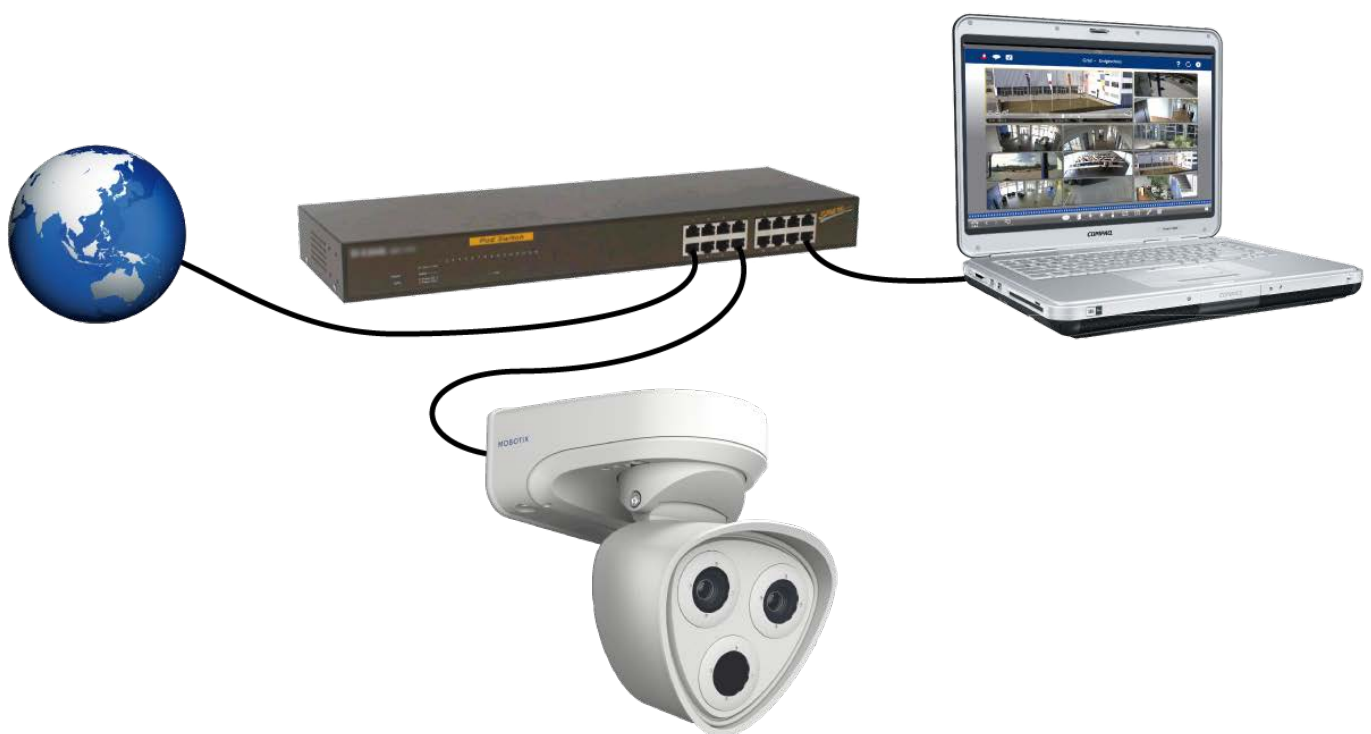
Abb. 24: Spannungsversorgung mit PoE-Switch nach PoE Plus (802.3at-2009)
