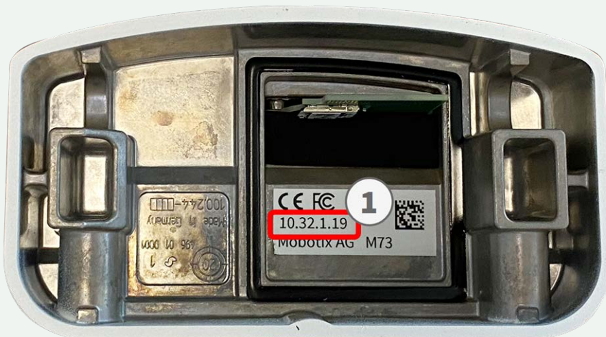
Abb. 5: IP-Adresse der Kamera auf der Rückseite des Kameragehäuses
