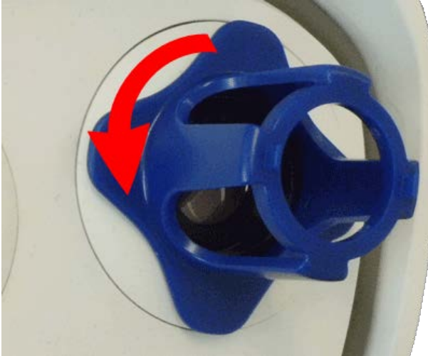
Abb. 43: Sensormodul im Gegenuhrzeigersinn bis zum Anschlag drehen
