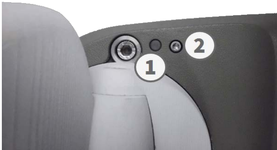
Abb. 34: Ansicht der M73 von unten mit LED (1) und Schraube mit Dichtung (2) und darunterliegendem Taster
